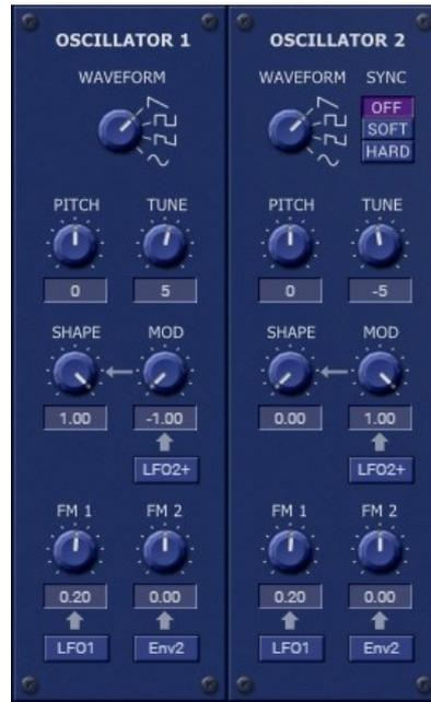
Les oscillateurs du Bloo disposent de quatre formes d'onde différentes : Dent-de-scie, Impulsion, Dent-de-scie/Impulsion (un mélange de Dent-de-scie et d'onde d'Impulsion) et Sinusoïdale. La forme des formes d'onde peut être modulée par n'importe quelle source de modulation unipolaire (voir la liste des sources de modulation). Dans le cas de la forme d'onde d'impulsion, cela équivaut à une modulation de la largeur de l'onde d'impulsion.
