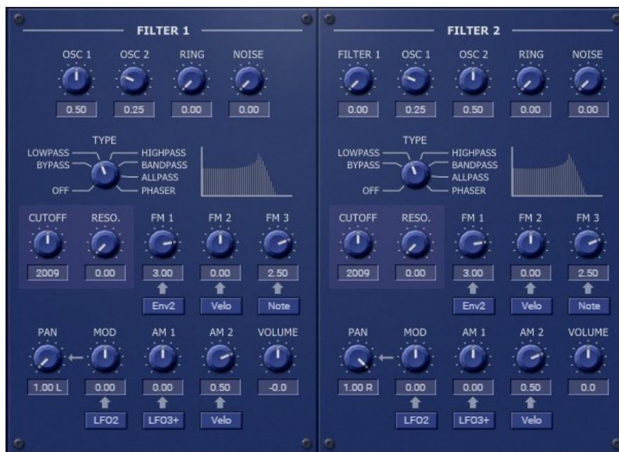
Chacun des deux filtres du Bloo est divisé en trois sections : le mixeur d'entrée, le module de filtre et l'amplificateur de sortie. Le mixeur d'entrée reçoit les signaux de sortie des oscillateurs 1 et 2, du modulateur en anneau (sortie de l'oscillateur 1 multiplié par la sortie de l'oscillateur 2) et du générateur de bruit blanc. De plus, le mixeur du filtre 2 permet de récupérer la sortie du filtre 1.
