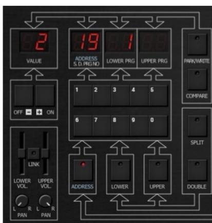
OK, il ne vous reste plus qu'à passer en mode EDIT en cliquant sur le bouton ADDRESS. Tapez le numéro d'un paramètre à l'aide du pavé numérique et modifiez la valeur de ce paramètre à l'aide des touches OFF/- et ON/+ (heureusement, les valeurs augmentent ou diminuent rapidement lorsque vous "maintenez" l'un des boutons un peu plus longtemps).
