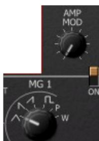
Après les résonateurs, le signal passe par un modulateur d'amplitude qui le multiplie par le signal de MG1 (peut être désactivé en utilisant le commutateur en bas de la section de modulation d'amplitude). Ici, le potentiomètre AMP MOD règle l'intensité et le caractère de l'effet comme suit :
