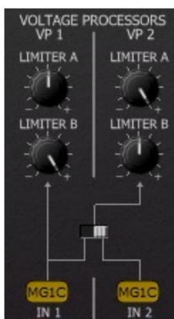
Dans le FB-3300, il y a deux processeurs de tension VP1 et VP2. Ils sont utilisés pour traiter le signal d'une source de modulation (par exemple un MG ou le GEG) et pour produire un signal modifié. Voici comment cela fonctionne :
