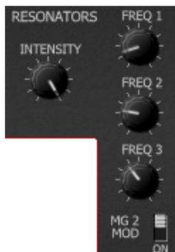
Comme indiqué précédemment ; les signaux de voix individuelles sont mélangés en un seul signal mono et envoyés dans la section de résonateurs. Il s'agit essentiellement d'un agencement en parallèle de trois filtres passe-bande high-Q (c'est à dire des résonateurs) dont la fréquence centrale est réglable individuellement. Le contrôle INTENSITY détermine la balance entre le signal original et le signal d'effet.
