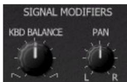
Après la modulation de l'amplitude, le signal est traité par une caractéristique unique : Le suivi de clavier qui ajuste le volume selon la hauteur des notes jouées sur le clavier. Avec ce contrôle, vous pouvez atténuer les notes sur l'extrémité inférieure ou supérieure du clavier.
