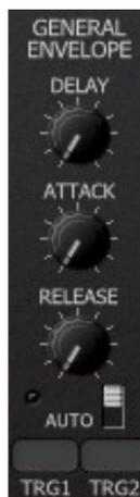
Le générateur d'enveloppe général est une enveloppe de type AR avec un paramètre Delay supplémentaire. Il peut être transformé en enveloppe de type AD en activant le commutateur AUTO. Dans ce cas, le GEG une fois déclenché ignorera la phase de sustain et ira directement en phase de relâchement.
