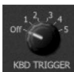
Le générateur d'enveloppe général peut être déclenché par tout signal de déclenchement raccordé à l'un des deux connecteurs TRG1 et TRG2. La source KBD TRIGGER est particulièrement intéressante : Vous pouvez sélectionner combien de touches doivent être pressées (de 1 à 5) avant que cette source de déclenchement ne soit déclenchée (en position OFF par défaut, le clavier ne la déclenche pas).
