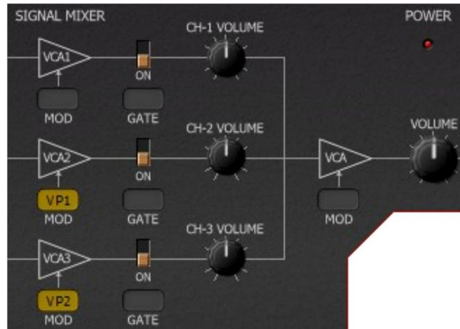
Les signaux des trois blocs sont résumés dans la section Signal Mixer. Chaque signal peut être réglé en volume et modulé via le VCA par une source de modulation (connecteur MOD). En outre, chaque signal peut être déclenché manuellement ou par une source de modulation différente (connecteur GATE). Ici, toute tension supérieure à 0V met la porte sur ON (à condition que le commutateur associé soit également réglé sur ON), alors que les tensions inférieures à 0V le règle sur OFF.
