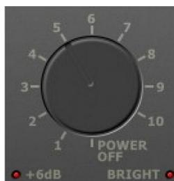
Le premier amplifie le niveau de sortie total de 6 dB et le second simule le son du Poly-800 en l'amincissant un peu ("THIN" n'est pas adapté pour une fonction - je préfère l'appeler "BRIGHT").
