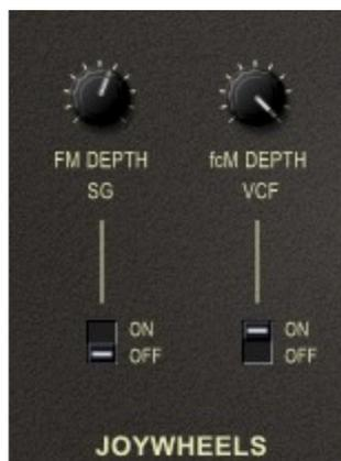
Le Delta original dispose d'un joystick pour la modulation : L'axe horizontal contrôle la fréquence de coupure du filtre tandis que l'axe vertical contrôle l'intensité de la modulation du LFO (en poussant le joystick vers le haut), ou le Noise (en tirant le joystick vers le bas).
