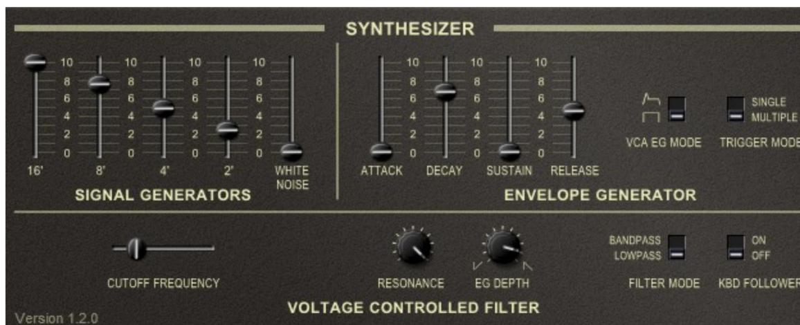
La section Synthesizer est le cœur même du Nabla. Elle dispose d'un oscillateur polyphonique, d'une section de filtre et d'amplification. Elle possède également une enveloppe ADSR qui contrôle la fréquence de coupure du filtre et/ou l'amplitude, un LFO pour la modulation du Vibrato ou de la fréquence de coupure du filtre. Cela reprend un peu le design classique du Juno-6 n'est-ce pas ?
