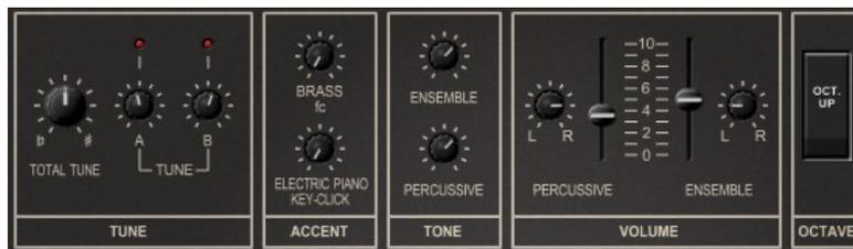
La section Tune contrôle le réglage global ("Total Tune") et le réglage individuel de la banque d'oscillateurs 2 (appelée ici "Tune A") et de la banque d'oscillateurs 3 ("Tune B"). Les LED au-dessus des boutons A/B Tune visualisent l'intensité des "battements" du désaccord.
