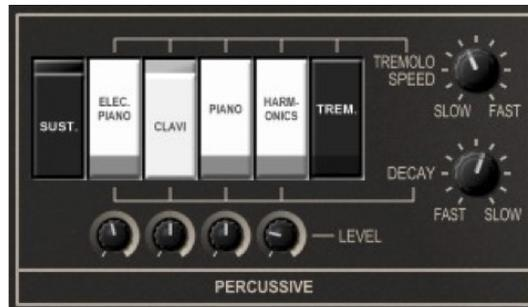
La section Percussive comporte également un effet Tremolo qui peut être (dés)activé à l'aide du bouton "TREM.". La vitesse de l'effet peut également être réglée.
