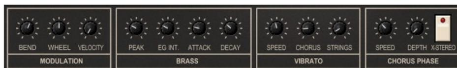
Le bloc modulation comprend l'intensité du Pitch Bend ( $\pm$  notes) et la molette de modulation contrôlant la vitesse (maximale) de la phase de chorus. Contrairement au Lambda, le Ny accepte également les informations de vitesse.
