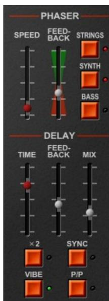
Le Phaser s'inspire vaguement du célèbre Electro Harmonix Small Stone et de son filtre passe-tout à 4 niveaux. "SPEED" règle la vitesse de modulation et "FEEDBACK" le niveau de feedback positif ou négatif; des réglages extrêmes peuvent vous faire vibrer les oreilles. Le Phaser fonctionne en stéréo et peut être activé individuellement pour chacune des trois sections sonores.
