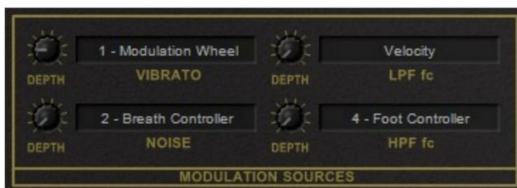
Il y a quatre chemins de modulation disponibles dans le Stigma : Vibrato (joystick 1 axe Y haut contrôle la profondeur de la modulation du vibrato), Noise (joystick 1 axe Y bas contrôle la profondeur de la modulation du bruit), LPF fc (joystick 2 axe X contrôle la fréquence de coupure des filtres passe-bas de la section Synthe) et HPF fc (joystick 2 axe Y contrôle la fréquence de coupure du filtre passe-haut de la section Synthe).
