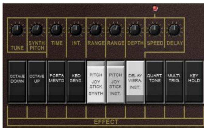
Le Pitch-Bend et la modulation par Vibrato ou Noise (voir le paragraphe Joysticks et molettes : Sources de modulation) peuvent être activés séparément pour les sections Synthe (VCO2) et Instrument (VCO1) via les commutateurs Pitch Joystick. Les boutons Range respectifs contrôlent l'intensité de l'effet de modulation. Le Delay Vibrato s'applique uniquement à la section Instrument, il est contrôlé par les boutons de profondeur, de vitesse et de temps de retard du Vibrato.
