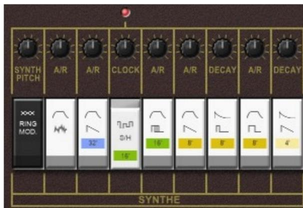
Il existe aussi un autre commutateur, Ring Modulator qui remplace la sortie standard de la section Synthe par le signal modulé en anneau provenant des sections Synthe et Instrument. Notez que pour entendre un son lorsque Ring Mod est activé, au moins une des deux sections doit être activée.
