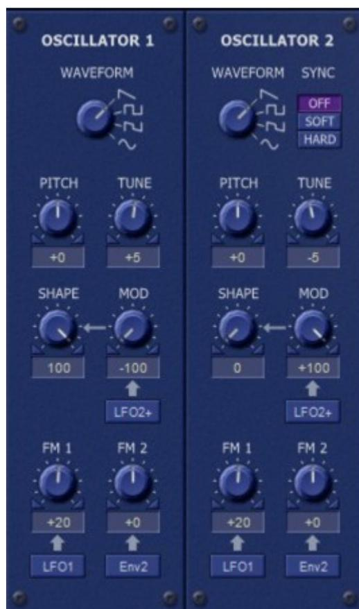
Les oscillateurs du Bloo disposent de quatre formes d'onde différentes : Dent-de-scie, Impulsion, Dent-de-scie/Impulsion (un mélange de Dent-de-scie et d'onde d'Impulsion) et Sinusoïdale. La forme des formes d'onde peut être modulée par n'importe quelle source de modulation unipolaire (voir la liste des sources de modulation). Dans le cas de la forme d'onde d'impulsion, cela équivaut à une modulation de la largeur de l'onde d'impulsion.
