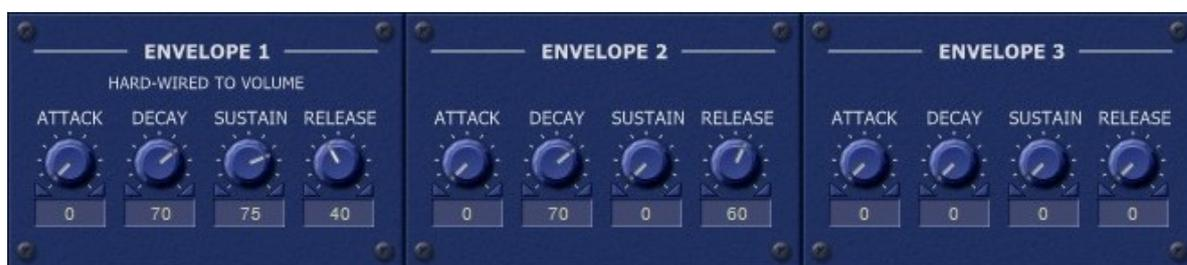
Les trois générateurs d'enveloppes du Blooo sont des générateurs ADSR standard avec des pentes exponentielles telles que celles que l'on trouve dans les synthétiseurs analogiques classiques. Notez que l'enveloppe 1 est destinée exclusivement aux amplificateurs de filtres et contrôle donc directement le contour de l'amplitude générale.
