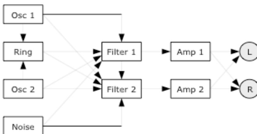
Chaque voix du Blooo comporte deux oscillateurs alimentant un modulateur en anneau. Les sorties individuelles des oscillateurs, du modulateur en anneau et du générateur de bruit blanc supplémentaire sont envoyées aux mixeurs d'entrée des deux filtres multi-modes. De plus, le mixeur du filtre 2 peut recevoir la sortie du filtre 1. Les sorties du filtre sont dirigées vers deux amplificateurs individuels avec contrôle du panoramique qui sont connectés au bus de sortie stéréo général.
