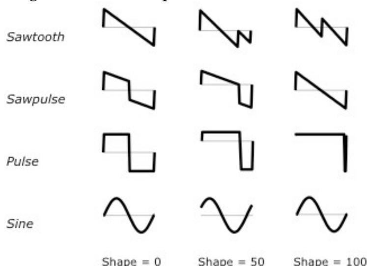
Notez que la forme d'onde en Dent-de-scie avec une valeur de forme de 100 équivaut à un mélange d'une onde en Dent-de-scie et d'une Dent-de-scie supplémentaire transposée d'une octave. Pour l'onde Sinusoïdale, la valeur de forme contrôle uniquement la phase de sa forme d'onde.
