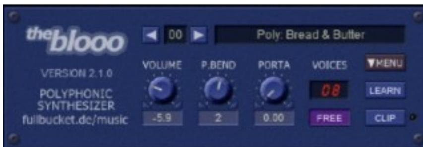
La section globale contient les paramètres communs tels que le volume, la plage du pitch-bend, le temps de portamento ainsi que les commandes de sélection de presets, le menu Options et le bouton MIDI Learn.
