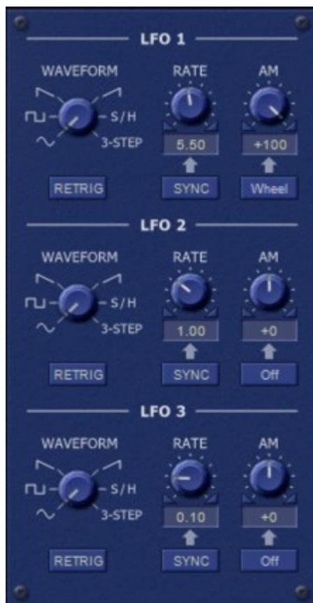
Les trois LFO's sont des générateurs de basse fréquence qui génèrent un signal périodique de 0 à 100 Hz ou qui peuvent être synchronisés au tempo de l'application hôte. Six formes d'onde sont disponibles : Sinusoïdale, Carrée, Dent-de-scie ascendante, Dent-de-scie descendante, Sample & Hold et en escalier à 3 états. Le paramètre Retrig détermine si les LFO's recommencent au début de la forme d'onde ou s'ils sont "libres" (similaire au mode Free des oscillateurs)
