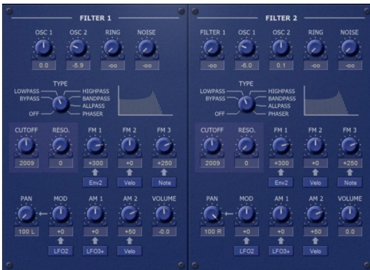
Chacun des deux filtres du Blooo est divisé en trois sections : le mixeur d'entrée, le module de filtre et l'amplificateur de sortie. Le mixeur d'entrée reçoit les signaux de sortie des oscillateurs 1 et 2, du modulateur en anneau (sortie de l'oscillateur 1 multiplié par la sortie de l'oscillateur 2) et du générateur de bruit blanc. De plus, le mixeur du filtre 2 permet de récupérer la sortie du filtre 1.
