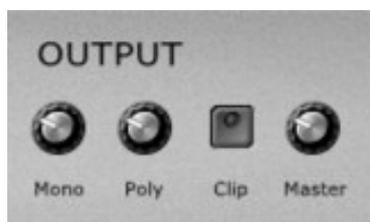
Pour finir, la section Output résume les signaux de sortie des sections Poly et Mono. Il y a aussi un limiteur de signal très simple (appelé Clip) qui est situé avant le contrôle du volume de sortie principal. Cependant, pour les signaux élevés, ce circuit a plutôt tendance à agir comme un effet de saturation.
