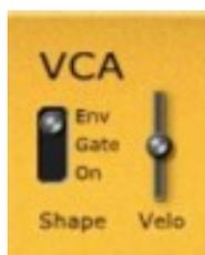
Comme source de modulation de l'amplitude du signal du synthétiseur mono, on peut sélectionner l'enveloppe ADSR ou la simple enveloppe Gate. De plus, il est possible de mettre le VCA en mode On permanent. C'est pratique lorsque la section Mono est configurée pour traiter uniquement la sortie de la section Poly. Dernière chose et pas des moindres, le VCA peut être modulé par la vitesse.
