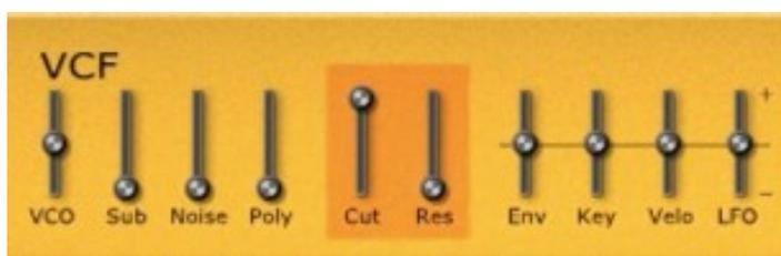
Il s'agit ici d'un filtre 4-pôles, capable d'entrer en auto-oscillation, il prend les sorties du VCO, du Sub-oscillateur générant une forme d'onde rectangle (une octave en dessous de la fréquence du VCO), du générateur de bruit blanc et de la section Poly comme signaux d'entrée. Sa fréquence de coupure peut être modulée positivement ou négativement par la vitesse, le suivi de clavier, le LFO et le générateur d'enveloppe ADSR.
