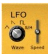
Le LFO dispose de quatre formes d'onde (Triangle, Dent-de-scie, Rectangle et Sample & Hold) qui peuvent moduler la fréquence du VCO, la largeur de l'onde d'impulsion et/ou la fréquence de coupure du VCF.
