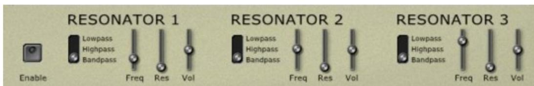
Le Deputy MarkII est équipé de trois filtres multi-mode indépendants 4-pôles (passe-bas, passe-haut et passe-bande), fonctionnant en parallèle sur la sortie globale de la section Poly. Bien qu’il ne soit pas possible de moduler leur fréquence de coupure, ces résonateurs se révèlent très pratiques quand il s’agit de créer des formants fixes.
