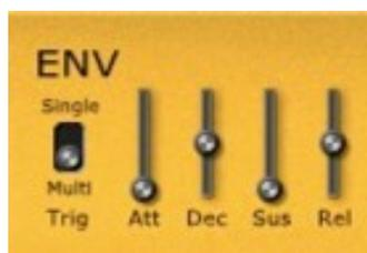
Le générateur d'enveloppe ADSR de la section Mono est identique à celui de la section Poly, il peut être utilisé en tant que source de modulation pour le VCF et le VCA
