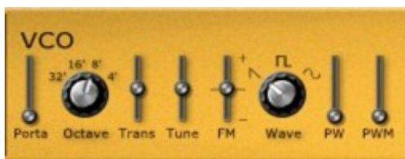
Le VCO propose trois formes d'onde (Dent-de-scie, Impulsion et Sinusoïdale) et quatre plages d'octaves (32', 16', 8' et 4'). La largeur de l'onde d'impulsion peut être modulée par le LFO et il est également possible d'accorder le VCO dans une plage de +/- 7 demi-tons.
