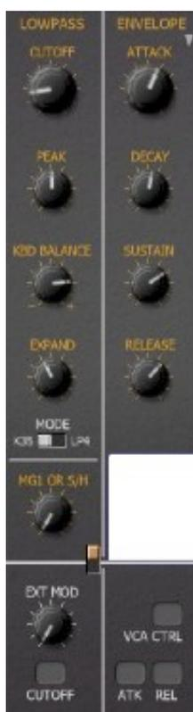
Le signal de sortie des générateurs de signaux alimente la section de filtre passe-bas avec résonance réglable (Peak). Contrairement au PS-3200 original, le type de filtre peut être choisi entre la modélisation de filtre Korg K-35 et un filtre 4-pôles Ladder classique.
