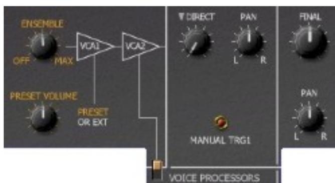
Après la modulation d'amplitude, le signal passe par un effet d'ensemble (commutable) tel qu'on le connaît sur les strings machines classiques des années 70'. Comparé au Ps-3200, l'effet d'ensemble du FB-3200 produit moins de souffle !
