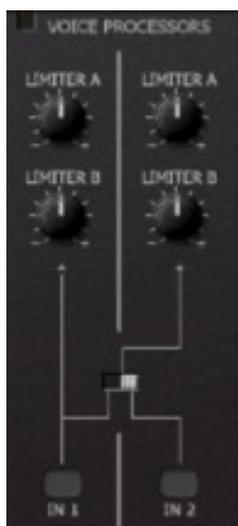
Dans le FB-3200, il y a deux processeurs de tension VP1 et VP2. Ils sont utilisés pour traiter le signal d'une source de modulation (par exemple MG ou GEG) pour produire un signal modifié. Voici comment cela fonctionne :
