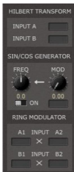
Le module Hilbert transform comporte deux transformation d'Hilbert : Un générateur Sinus/Cosinus et un double modulateur en anneau. Ces sections peuvent être combinées pour créer un décalage de fréquence de Bode. Il dispose des paramètres suivants :
