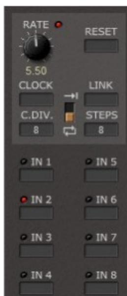
Le module Audio switch est un séquenceur huit-pas qui peut switcher entre huit entrées audio. Il est identique au module Sequential Switch, la seule différence est qu'il switche des signaux audio au lieu des signaux de modulation.
