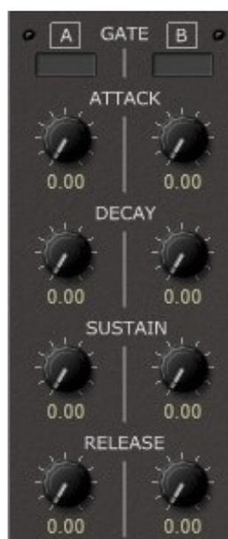
Le module Dual Envelope est constitué de deux générateurs ADSR de type exponentiel. Il dispose des paramètres suivants :
