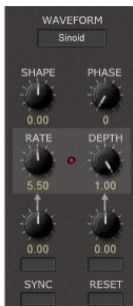
Le module LFO est un oscillateur de basse fréquence. Il dispose des paramètres suivants :
