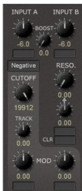
Le module Filter Comb est un filtre Comb (un retard très court avec un temps de retard réglable). Il dispose des paramètres suivants :
