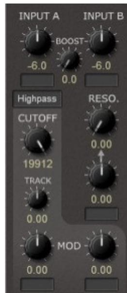
Le module Filter K35 est un filtre multi-mode modélisé à partir du circuit légendaire K35 de Korg. Il dispose des paramètres suivants :
