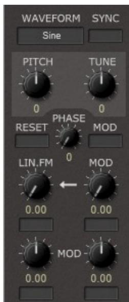
Le module FM Oscillator est un oscillateur à bande limitée qui permet la modulation de fréquence linéaire. Il dispose des paramètres suivants :
