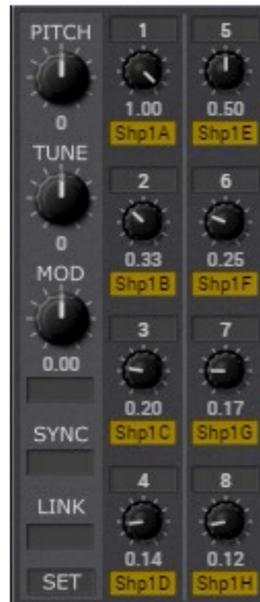
Le module Sine Oscillator produit 8 signaux sinusoïdaux (partiels) qui sont des multiples de la fréquence de base donnée. Ainsi, il peut être utilisé pour les techniques de synthèse additive :
