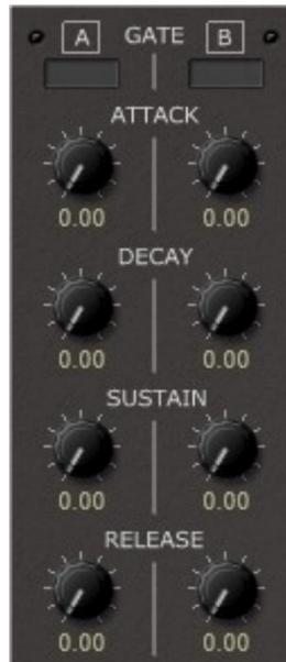
Le module Dual Envelope est constitué de deux générateurs ADSR de type linéaire. Il dispose des paramètres suivants :
