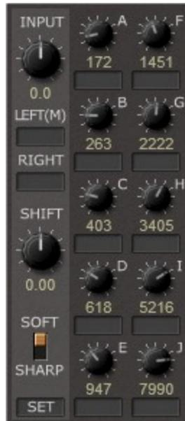
Le module Filter Bank est une banque de résonateurs à 10 stages généralement utilisée comme bloc de synthèse d'un vocodeur en conjonction avec l'analyseur. Il a les paramètres suivants :
