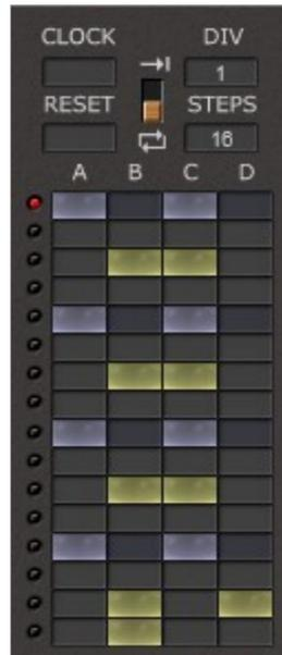
Le module Beat Sequencer est un séquenceur composé de quatre séquenceurs seize pas. Il dispose des paramètres suivants :
