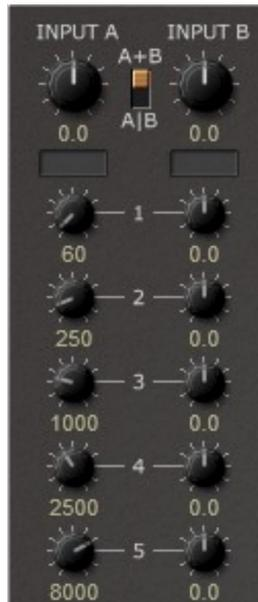
Le module Parametric EQ est un égaliseur paramétrique 5 bandes. Il dispose des paramètres suivants :
