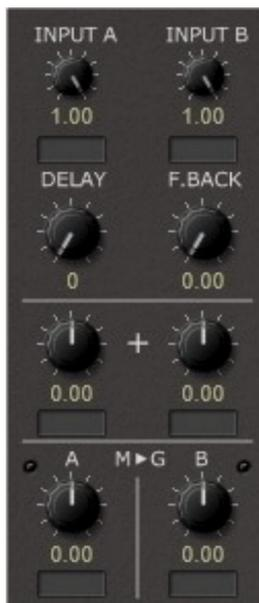
Le module utilitaire Modulation Signal Delay/M2G est constitué d'un retard de signal de modulation, d'un adder et de deux convertisseurs Modulation-to-Gate. Il dispose des paramètres suivants :
