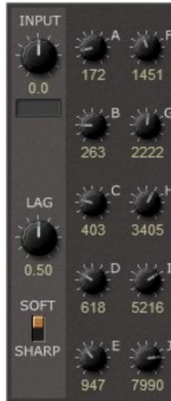
Le module Analyzer est une banque de résonateurs à 10 stages généralement utilisée comme bloc d'analyse d'un vocodeur en conjonction avec la banque de filtres. Il a les paramètres suivants :
