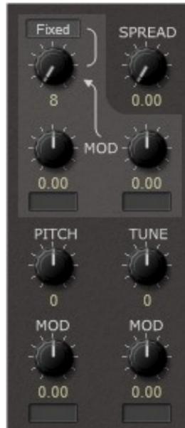
Le module Formant Oscillator est un oscillateur qui génère des formes d'onde à spectre ajustable par rapport à la fréquence de base ou à une fréquence fixe. Il dispose des paramètres suivants :
