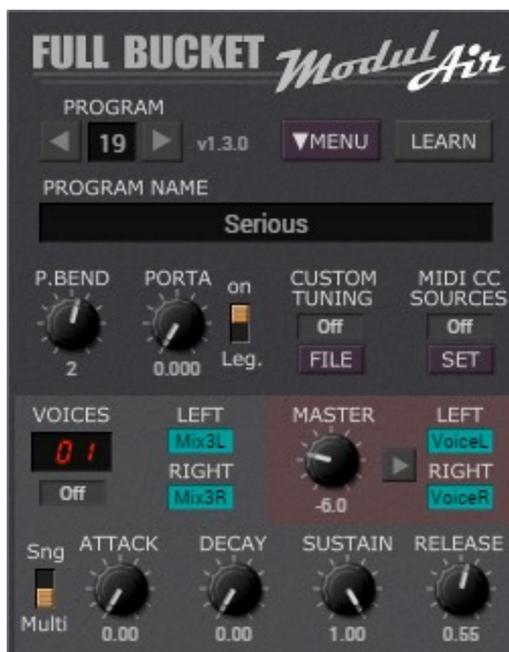
Pour envoyer un signal de somme de voix vers la sortie gauche et/ou droite de ModulAir, il doit être "connecté" sur les connecteurs GAUCHE et/ou DROITE. En cliquant sur un connecteur, vous ouvrez un menu dans lequel vous pouvez sélectionner la source de signal que vous souhaitez attribuer au connecteur. Les connecteurs GAUCHE/DROITE seront rouges si aucun signal n'est connecté - dans ce cas, vous n'entendrez aucun son sur le canal stéréo correspondant.
