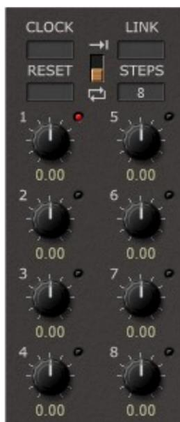
Le module Sequencer est un séquenceur huit-pas du style analogique. Il dispose des paramètres suivants :
