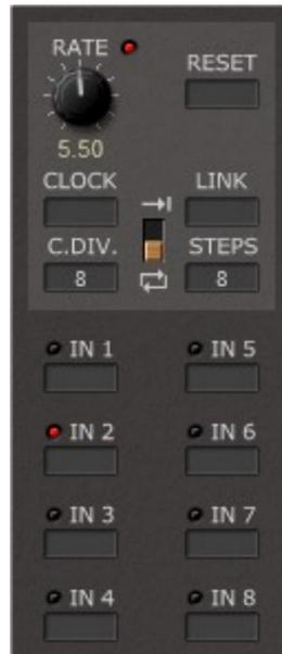
Le module Sequential switch est un séquenceur huit-pas qui peut switcher entre huit entrées de modulation maximum. Il dispose des paramètres suivants :
