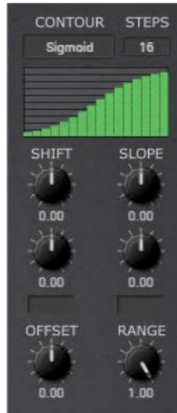
Le module Modulation Shape fournit jusqu'à 16 sorties de signal de modulation qui sont dérivées d'une "forme" commune. Il est très utile en conjonction par exemple avec les modules Sines Oscillator ou Filter Bank :
