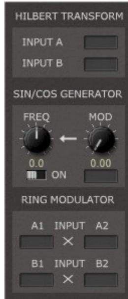
Le module Hilbert transform comporte deux transformation d'Hilbert : Un générateur Sinus/Cosinus et un double modulateur en anneau. Ces sections peuvent être combinées pour créer un décaleur de fréquence de Bode. Il dispose des paramètres suivants :
